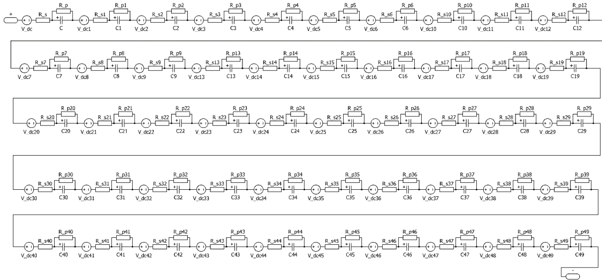
Slika 3.2 Pojednostavljeni simulacijski model litij-ionskih baterija
