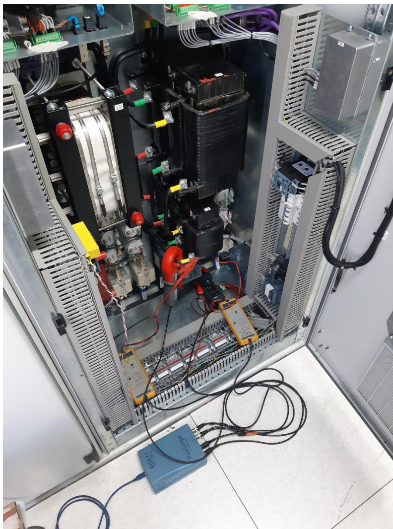
Sl. 3.1. Fotografija mjerne opreme i LCL filtra tijekom snimanja valnih oblika napona i struja usmjerivača snage 100 kVA s LCL filtrom tipa B
