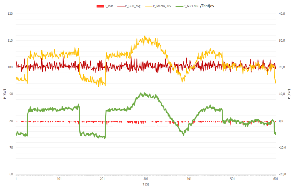
Slika 11. Rotirajuća rezerva preko baterijskog spremnika
