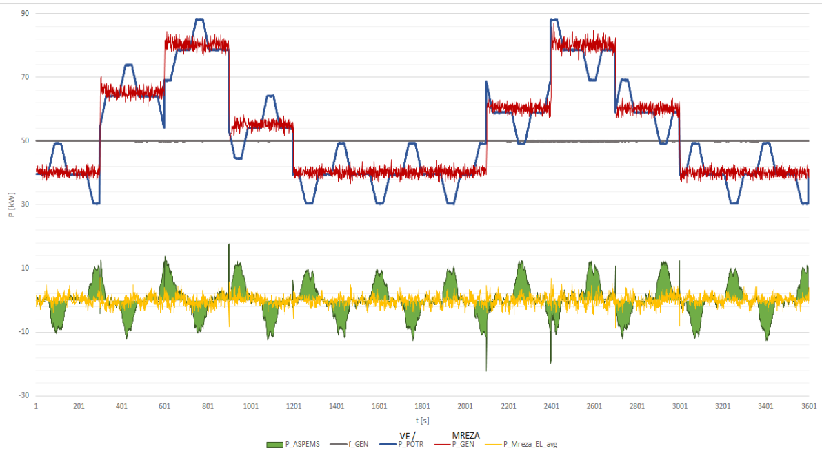
Slika 6. Isporuca dan unaprijed predviđene radne snage VE uporabom aktivnog sustava za pohranu električne energije
